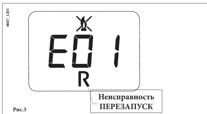
Для перезапуска котла установите переключатель режимов (Рис.2) на 2 сек в положение «R». При повторных срабатываниях данного устройства обратитесь в обслуживающую организацию.
